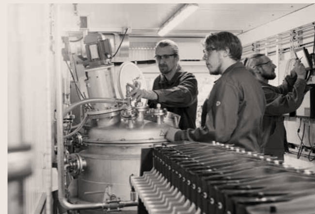
Im August 2017 wurde der erste BRAIN BioXtractor am Hauptsitz des Unternehmens in Zwingenberg aufgestellt. Mit dieser Demonstrationsanlage können jährlich bis zu sechs Tonnen Rohstoffmaterial verarbeitet werden.
